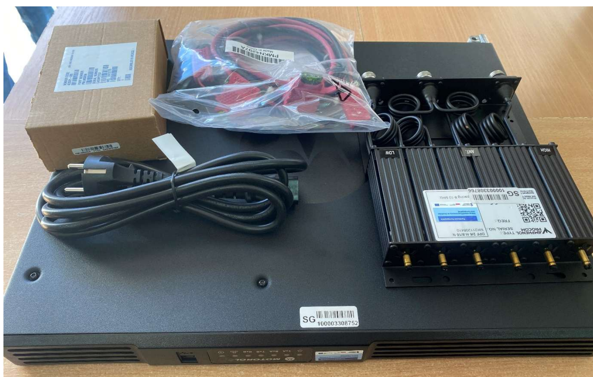
Stacja retransmisyjna komplet
